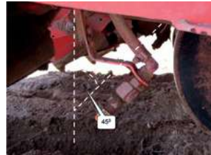
Правильна установка розпилювача — 45–55 градусів від вертикалі
