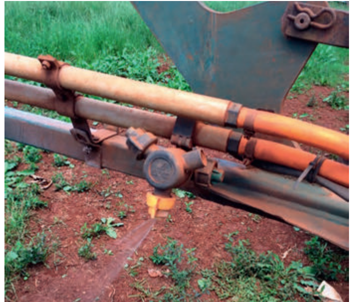
Рис. 12. Невчасне обстеження розпилювачів призводить до блокування їх роботи і зменшення терміну експлуатації.
