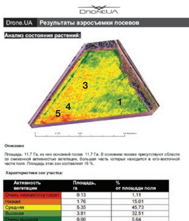
Рис. 3. Состояние растений подсолнечника на основе картирования в инфракрасном спектре
