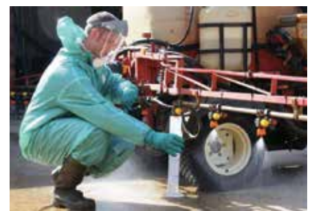
Рис. 3. Визначення якості внесення препаратів за допомогою водочутливого паперу. Видно рівень розподілення робочого розчину і щільність покриття рослин
