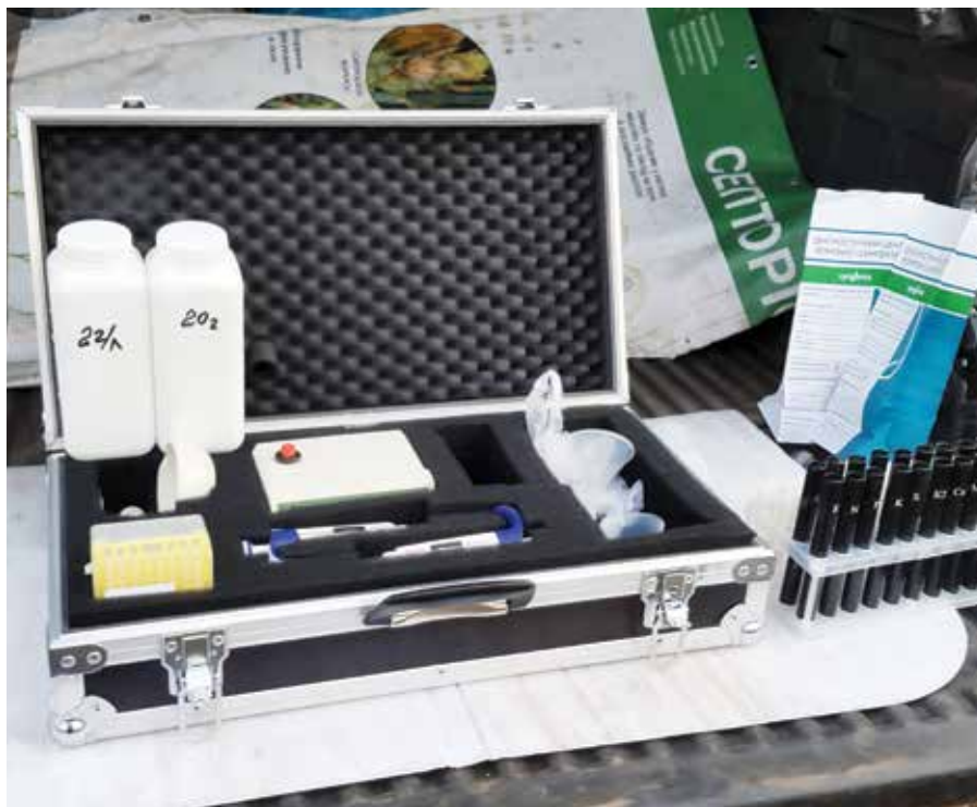
Рис. 2. Польова лабораторія з визначення мікро- і макроелементів та протокол дослідження
