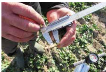
в) визначення вологості ґрунту (ліворуч) і щільності ґрунту та товщини кореневої шийки ріпаку (праворуч)
