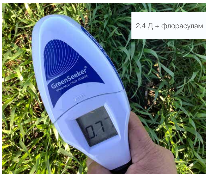
Фото. 4, 5. Порівняння фітотоксичної дії препаратів приладом GreenSeeker на 5-й день після внесення.
